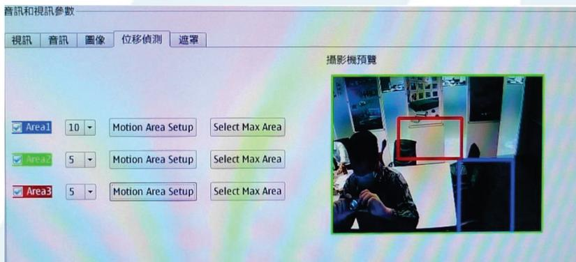
點按藍綠紅方塊選單旁的 **Motion Area Setup**，接著以滑鼠在影像上點選並用拖曳的方式畫出要偵測的區域。點按 **Select Max Area** 來包覆整個畫面。
