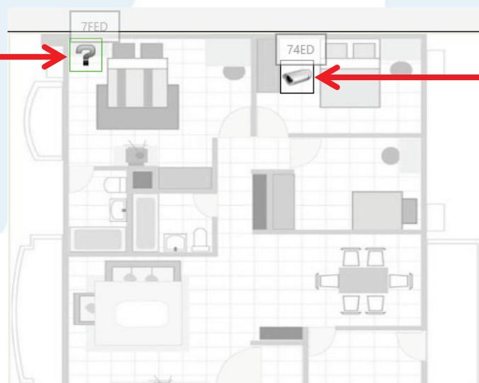
NVR 系統能經由內部資料庫自行辨識該攝影機之機型，並根據該機型資訊顯示其圖標外型。
